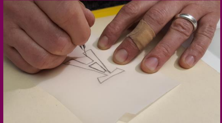
Abb. 54: Perforieren der Ornamentvorlage
