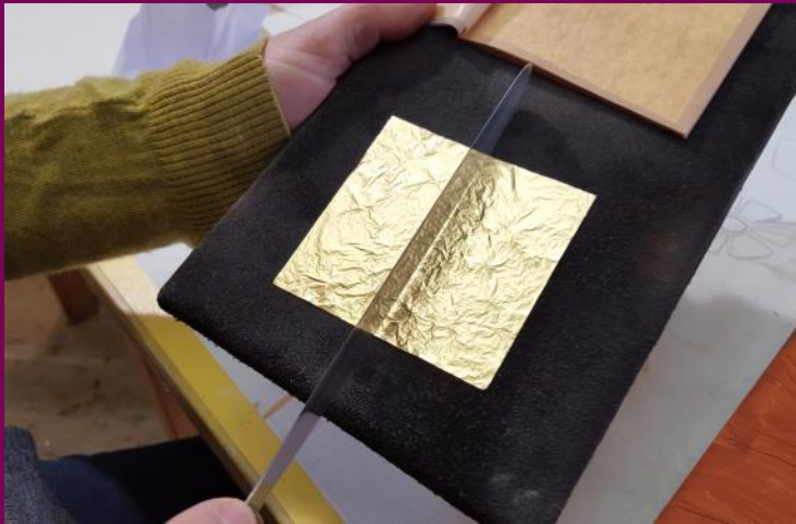
Abb. 42: Goldfolie schneiden mit dem Vergoldermesser
